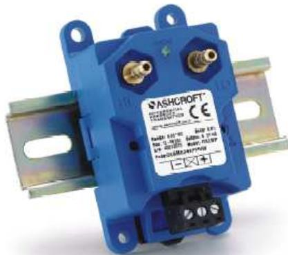
Dieser Messumformer basiert auf einem Sensorelement mit mikromechanisch gefertigtem Differentialkondensator in patentierter Silizium-Glas-Technologie. Die extrem dünne Einkristall-Membran ermöglicht eine exzellente Wiederholbarkeit und Langzeitstabilität.
