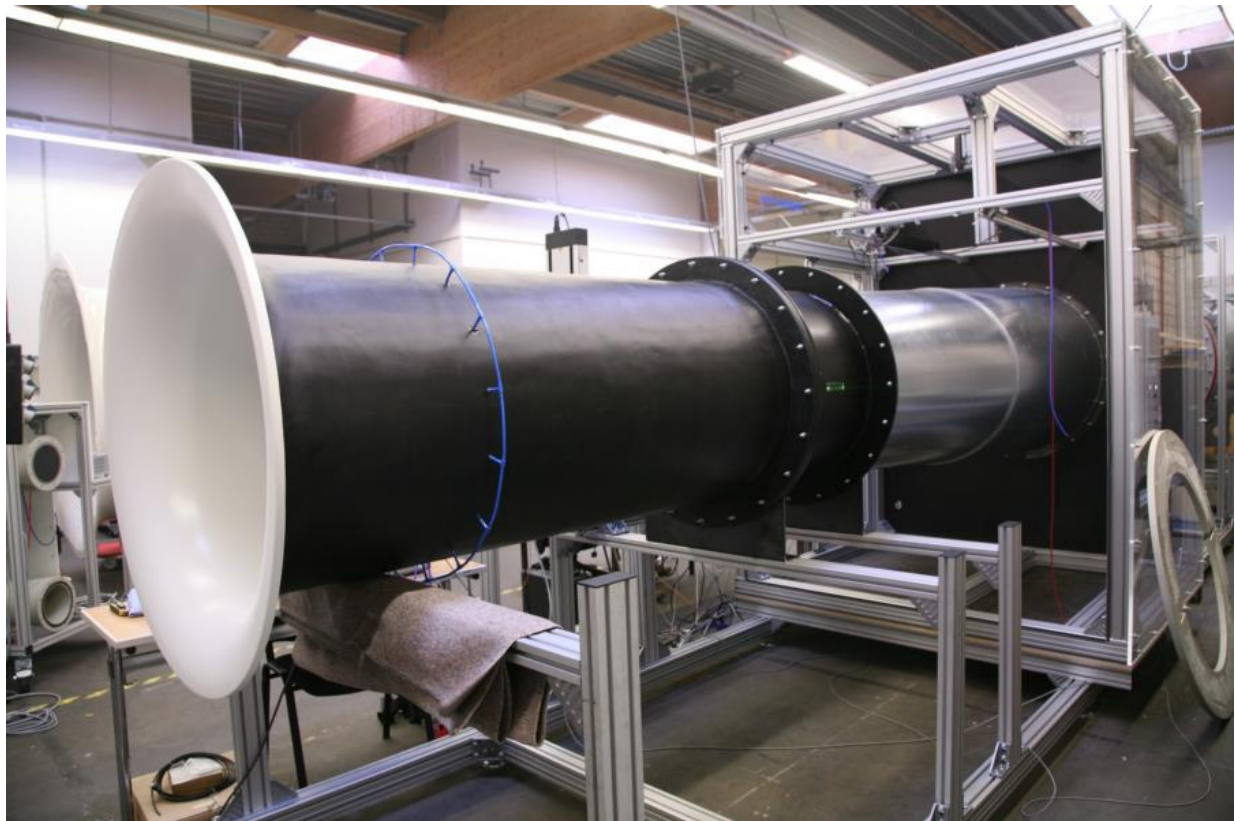
Abbildung 1 GFK-Einlaufmessdüse Durchmesser 700 mm
